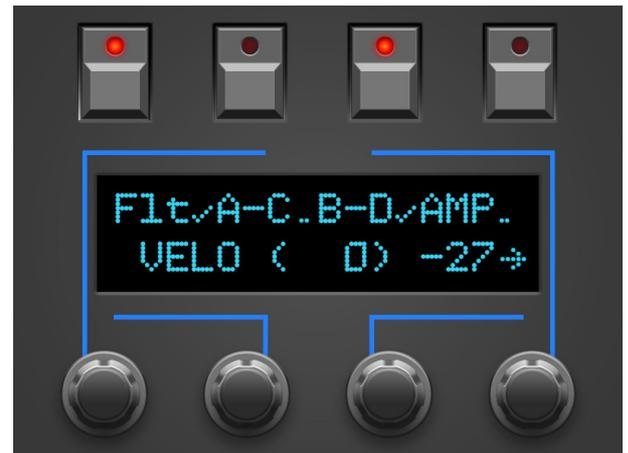
Du kannst mit den 4 Tastern über dem Display die angezeigten Modulationsziele nun einfach an oder ausschalten.
