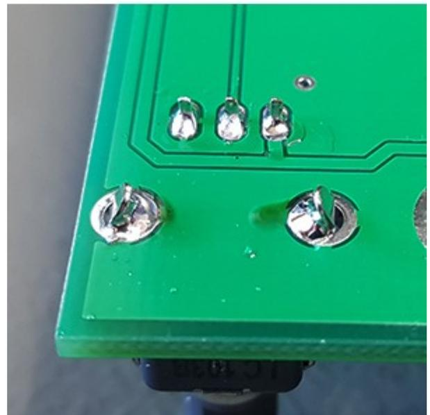
Sei hier nicht sparsam mit Lötzinn damit die Potis guten mechanischen Halt haben. Im unteren Foto erkennst Du, daß das Lötzinn gar nicht ganz bis auf die andere Klammerseite geflossen ist. Das ist auch nicht unbedingt nötig. Die Klammern gehen dem Poti trotzdem genügend Halt, solange die Lötstelle sauber ist und das Platinenpad wirklich mit der Klammer verbunden hat.
