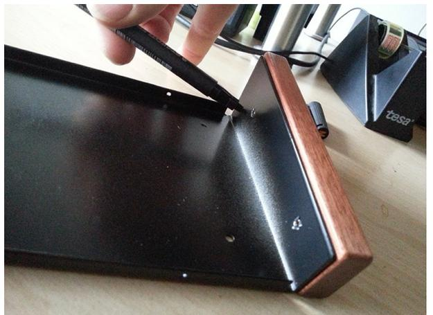
5. Schrauben möglichst exakt auf die angezeichneten Punkte eindrehen, nicht bis zum Anschlag. Das Vorbohren mit den Schrauben erleichtert das einschrauben aus Schritt 6 ungemein. Die Schrauben dann natürlich wieder rausdrehen :-)
